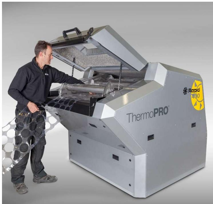
Estas máquinas combinan funciones ya probadas en otras granuladoras Rapid – doble tijera y un diseño a “corazón abierto” – teniendo un diseño óptimo para cambios en producciones rápidas y operativa 24/7, de fácil mantenimiento y con una base de composite mineral que le otorga una alta estabilidad y poca contaminación acústica, gracias a su caja modular de sonido (Rapid Super Sound Proof) elemento opcional.
